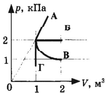
2. На рисунке показаны графики четырех процессов изменения состояния идеального газа. Какой процесс является изотермическим расширением?
